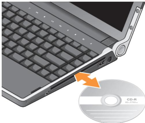
Zum Auswerfen einer Disc aus dem Gerät drücken Sie sanft auf die Auswurf-taste
